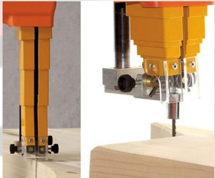
El sistema de fuelles es un sistema telescópico de protección de la hoja, que se puede ajustar en función de la altura de corte que se va a realizar, garantizando así, la seguridad en la etapa del corte.
